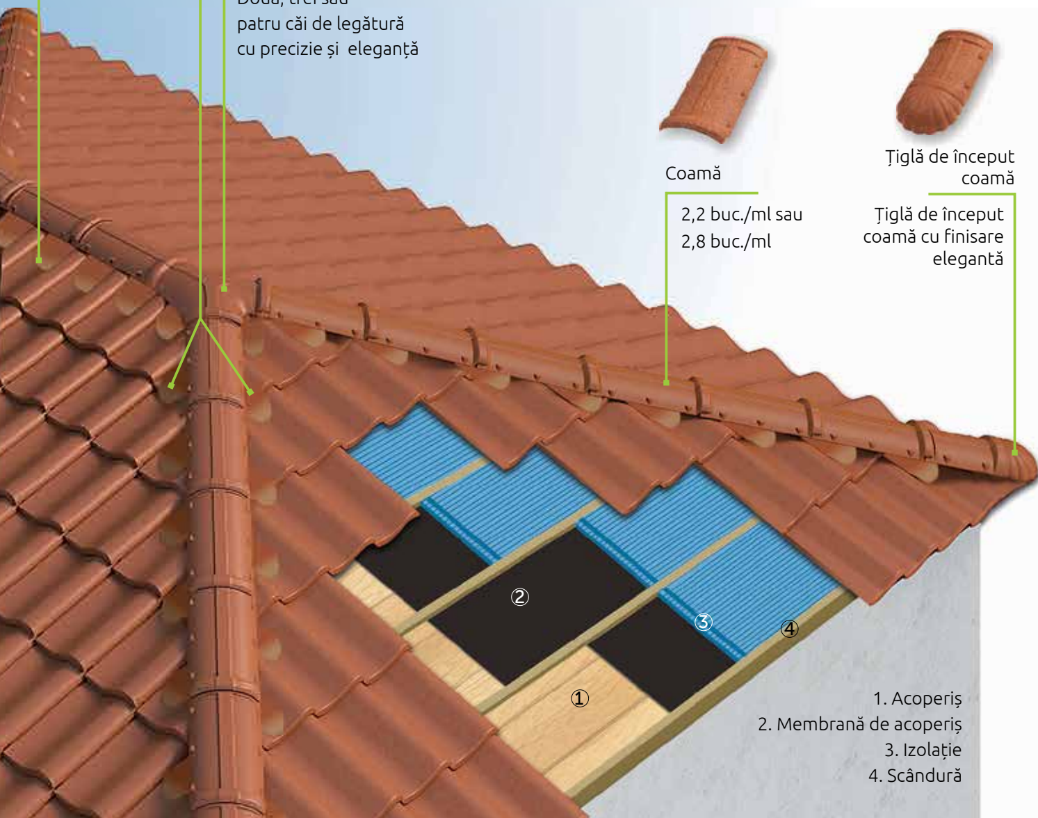
Tigla de ramificație coama cu 3 canale
